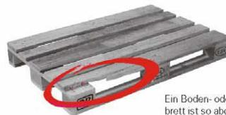
Ein Boden- oder Deckrandbrett ist so abgesplittert, daß mehr als ein Nagel- oder Schraubenschaft sichtbar ist.
