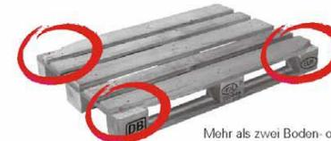
Mehr als zwei Boden- oder Deckrandbretter sind so abgesplittert, daß mehr als ein Nagel- oder Schraubenschaft sichtbar ist.
